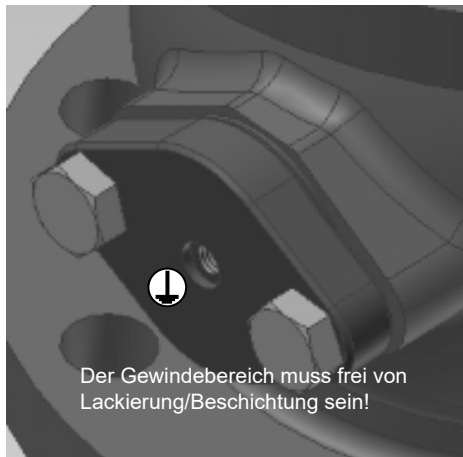
Fig. 5-1: Erdungsanschluss Ventil Typ 72, 73, 82
