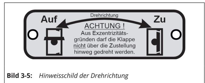
Bild 3-5: Hinweisschild der Drehrichtung
