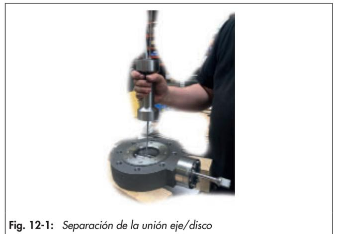
Fig. 12-1: Separación de la unión eje/disco
