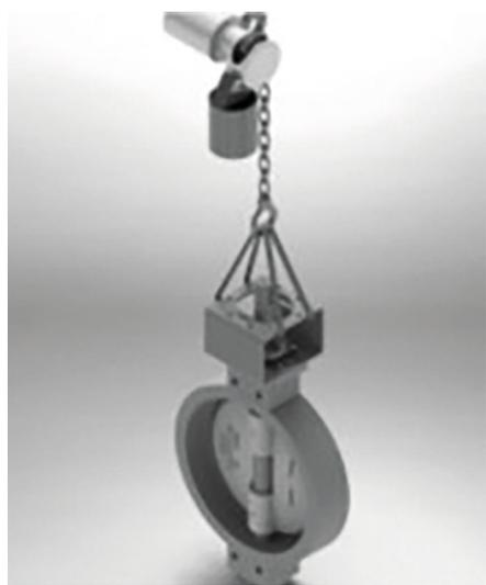
Fig. 4-1: Ejemplo de puntos de elevación de la válvula de mariposa
