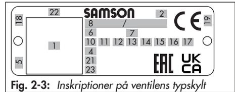
Fig. 2-3: Inskriptioner på ventilens typskylt
