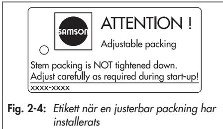
**Fig. 2-4:** Etikett när en justerbar packning har installerats
