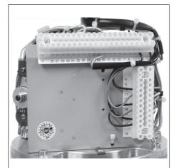
Fig. 9: Placas de bornes para la conexión eléctrica
