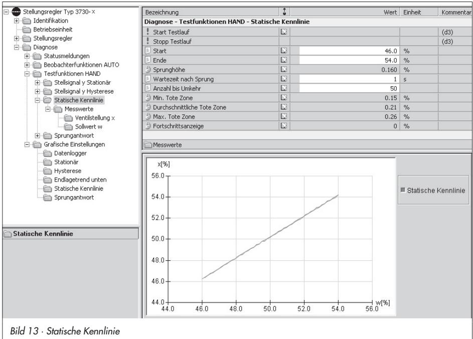
Bild 13 · Statische Kennlinie
