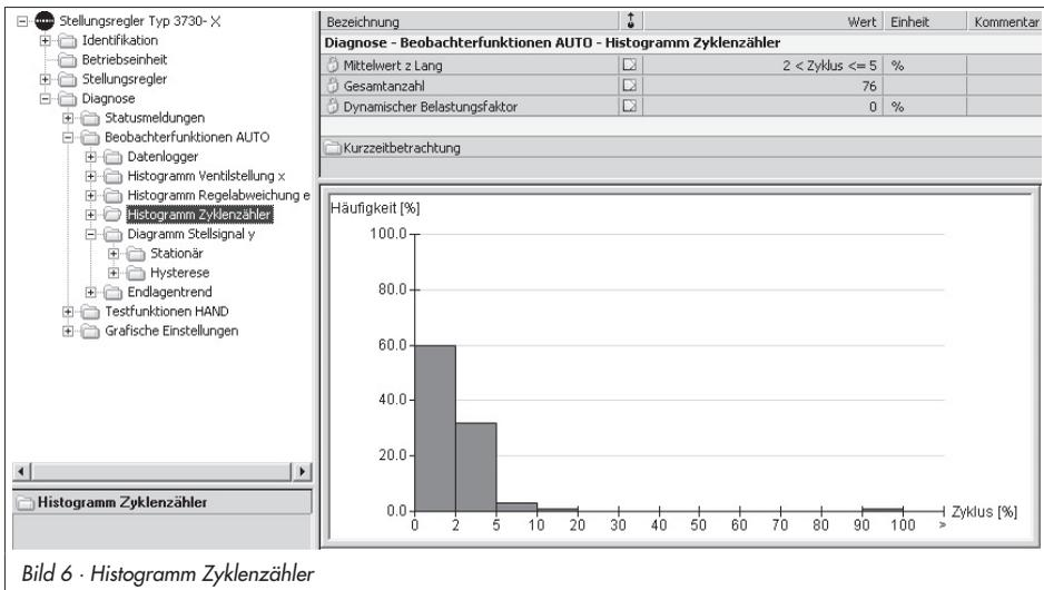
Bild 6 · Histogramm Zyklenzähler
