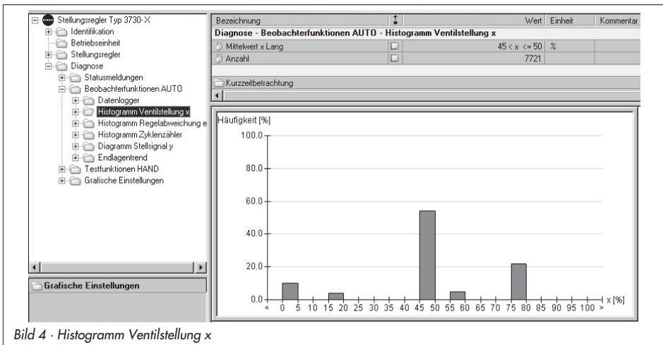
Bild 4 · Histogramm Ventilstellung x
