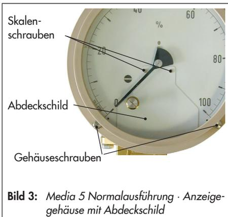
1. Die vier Gehäuseschrauben lösen. Gehäusedeckel abnehmen.
