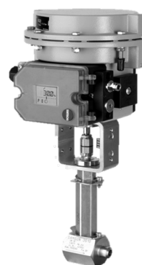
Antrieb Typ 3277-5 (120 cm 2 ) mit Ventil Typ 3510 und Stellungsregler Typ 3725 (Hardwareversion GI:00)
