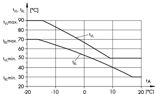
Bild 5 · Witterungsgeführte Vorlauftemperaturregelung mit gleitender Begrenzung der Rücklaufemperatur
