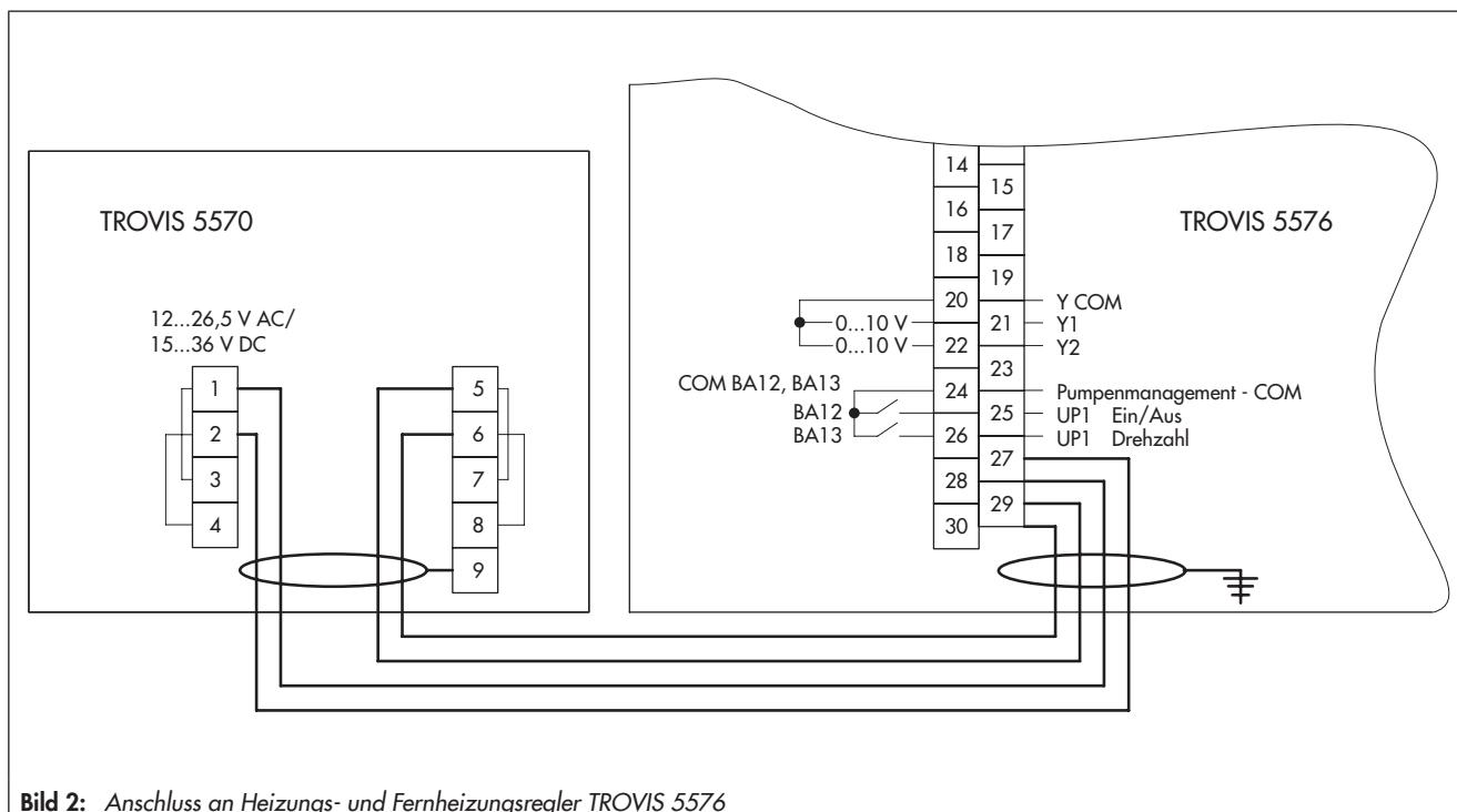
**Bild 2:** Anschluss an Heizungs- und Fernheizungsregler TROVIS 5576
