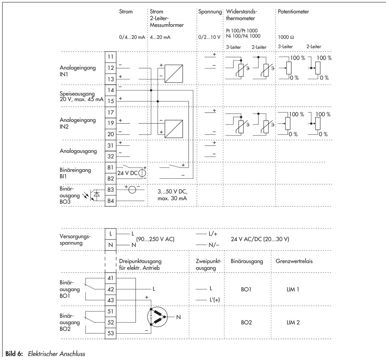
Bild 6: Elektrischer Anschluss
