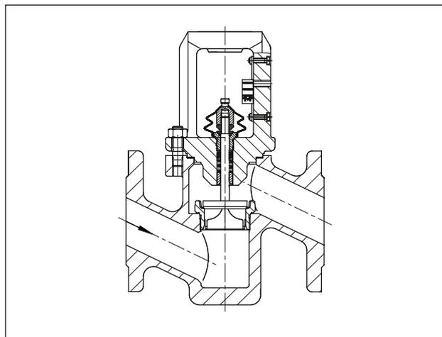
**Bild 2:** Ventil Typ 3241 PSA · Schmiedestahlausführung · NPS ½ bis 3
