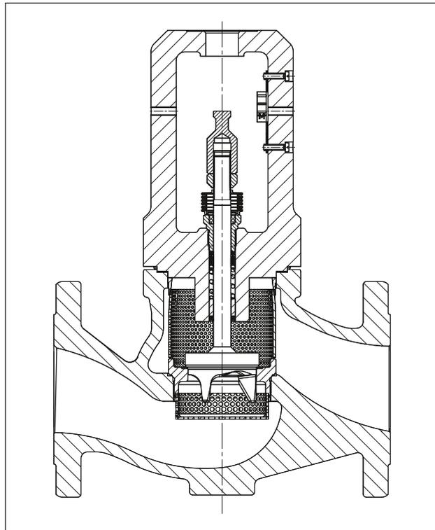
**Bild 1:** Ventil Typ 3241 PSA mit Strömungsteiler ST 1 PSA
