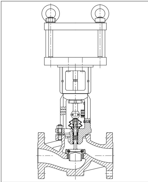
**Bild 3:** Ventil Typ 3241 mit pneumatischem Kolbenantrieb
