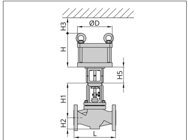
**Bild 6:** Typ 3241-9 PSA bis Nennweite DN 150/NPS 6 mit pneumatischem Kolbenantrieb Typ 3275A mit 314/380/490 cm<sup>2</sup>
