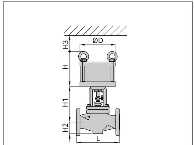
**Bild 7:** Typ 3241-9 PSA, Nennweite DN 100 bis 150/NPS 4 bis 6 mit pneumatischem Kolbenantrieb Typ 3275A mit 804 cm<sup>2</sup>
