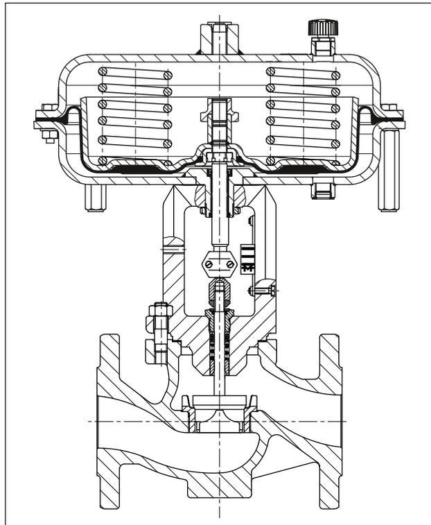
**Bild 1:** Stellventil Typ 3241-1 · DN 15A bis 150A
