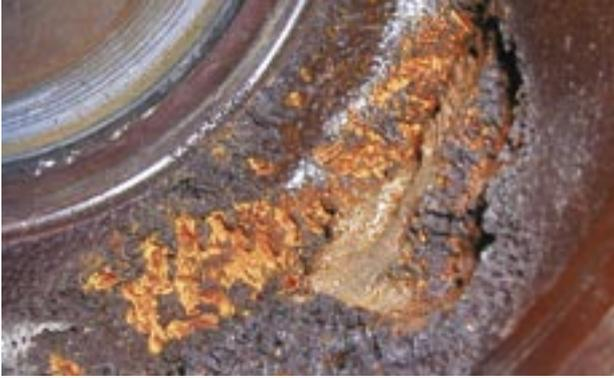
Ein durch Kavitation oberhalb der Sitzbrücke erodiertes Ventilgehäuse. Fortschreitende Kavitationserosion führt zu äußeren Undichtigkeiten.
