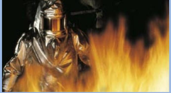
Aufgrund seiner extremen Hitzebeständigkeit besteht Feuerschutzkleidung oftmals zusätzlich aus einer Lage Twaron®.
