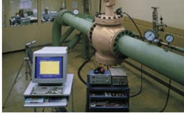
Die ventilspezifischen  $x_{Fz}$ -Werte werden auf Prüfstrecken empirisch ermittelt, um Geräusch- und Erosionsverhalten vorausberechnen zu können.
